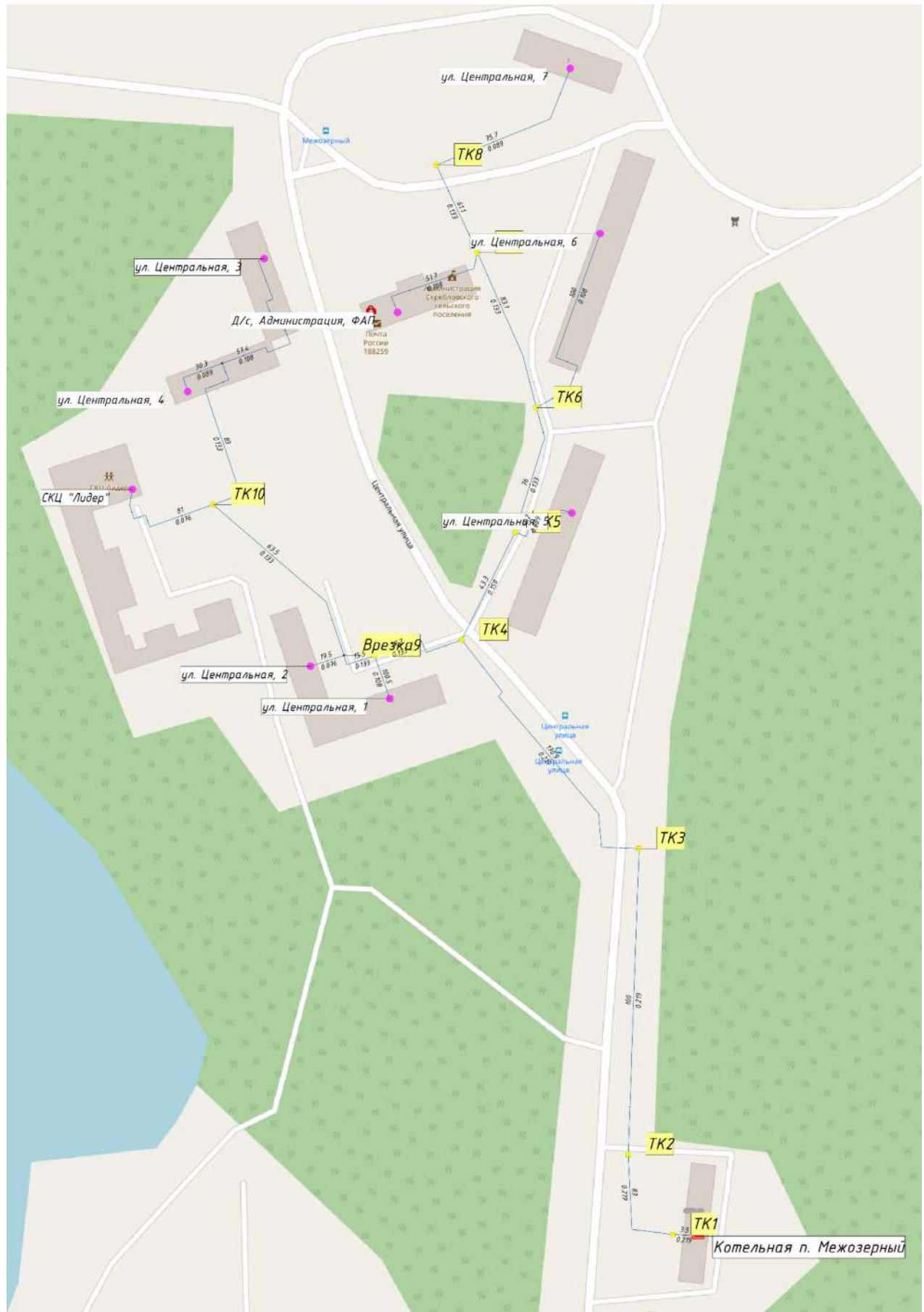
Рисунок 5.Схема тепловых сетей от котельной п. Межозерный
