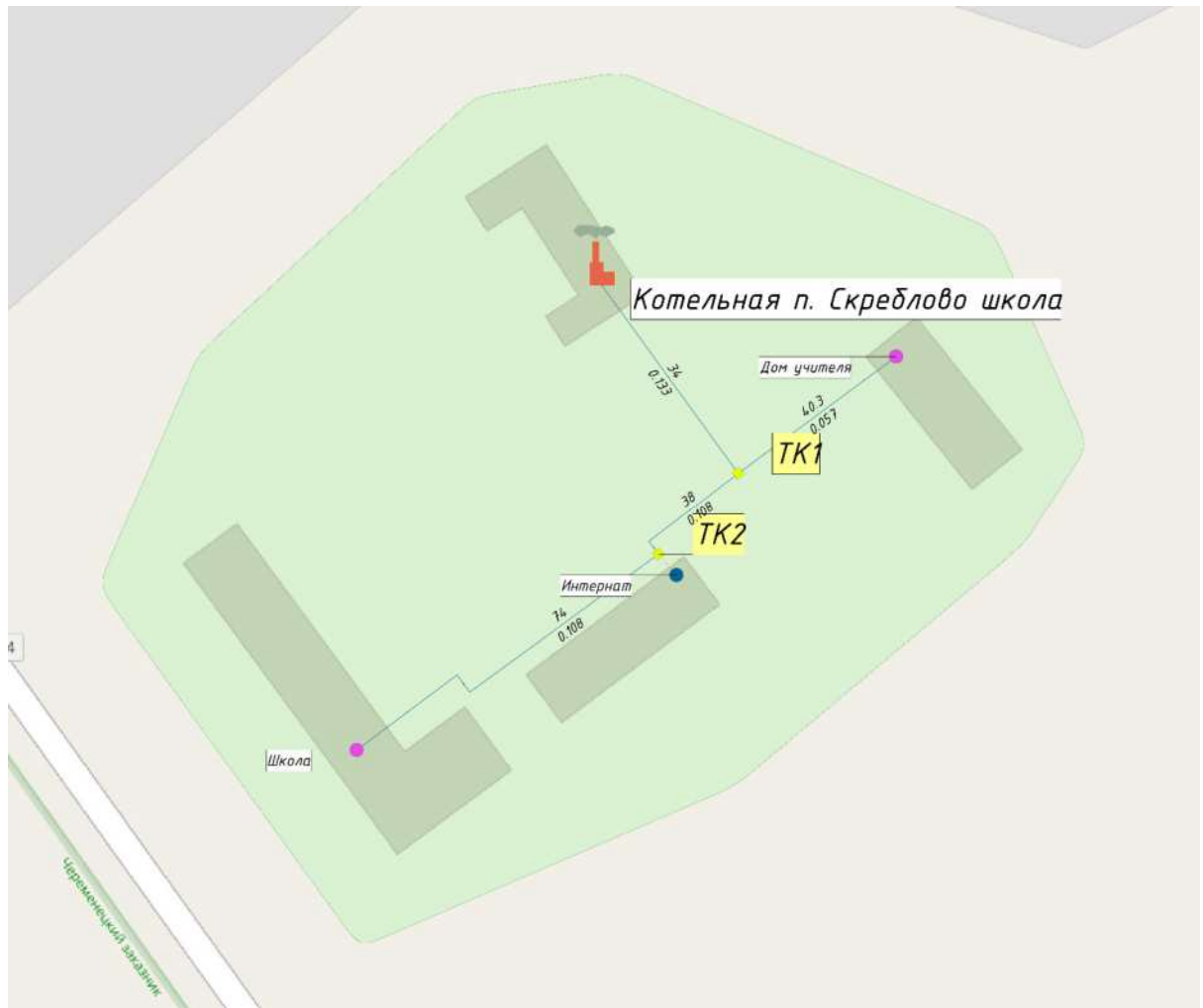
Рисунок 10. Зона действия котельной п. Скреблово школа
