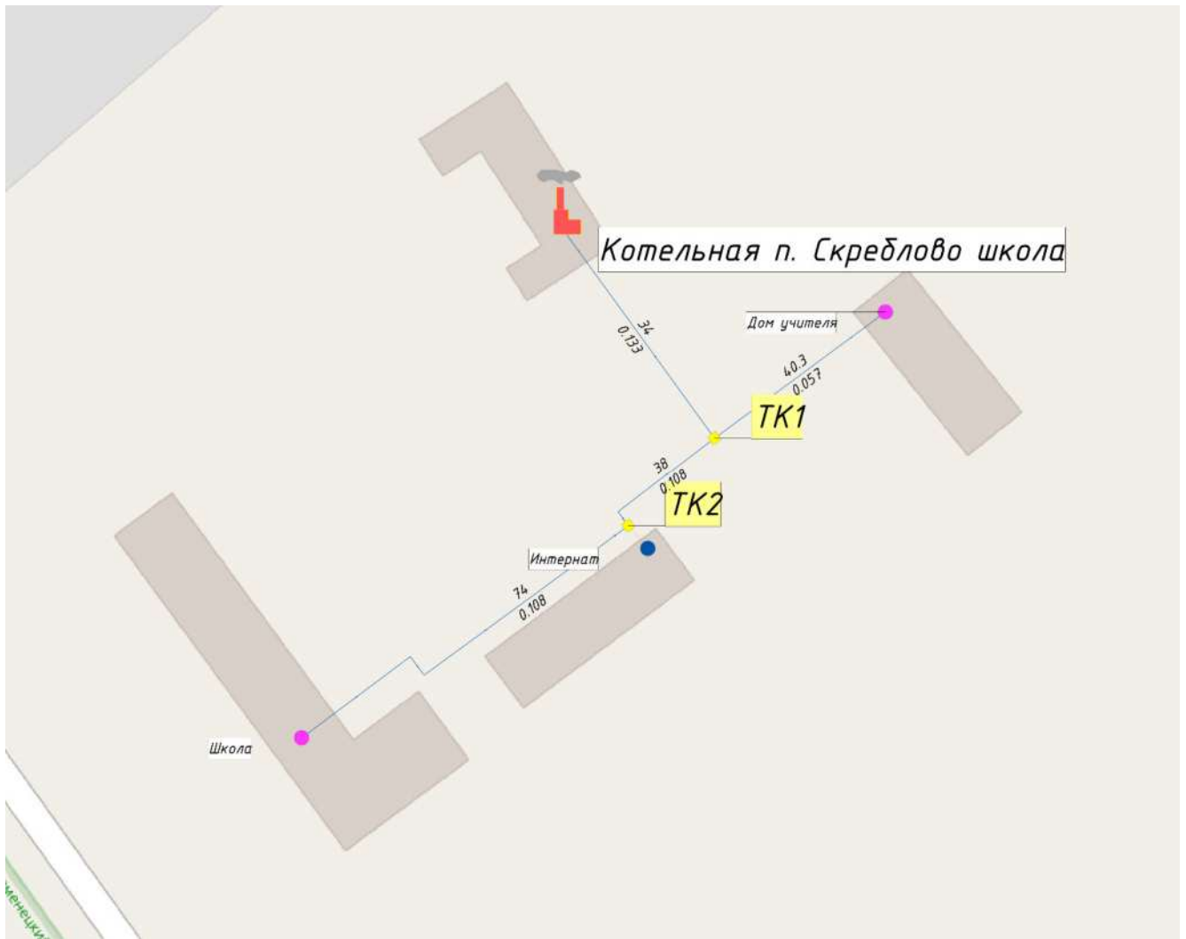
Рисунок 4. Схема тепловых сетей от котельной п. Скреблово школа
