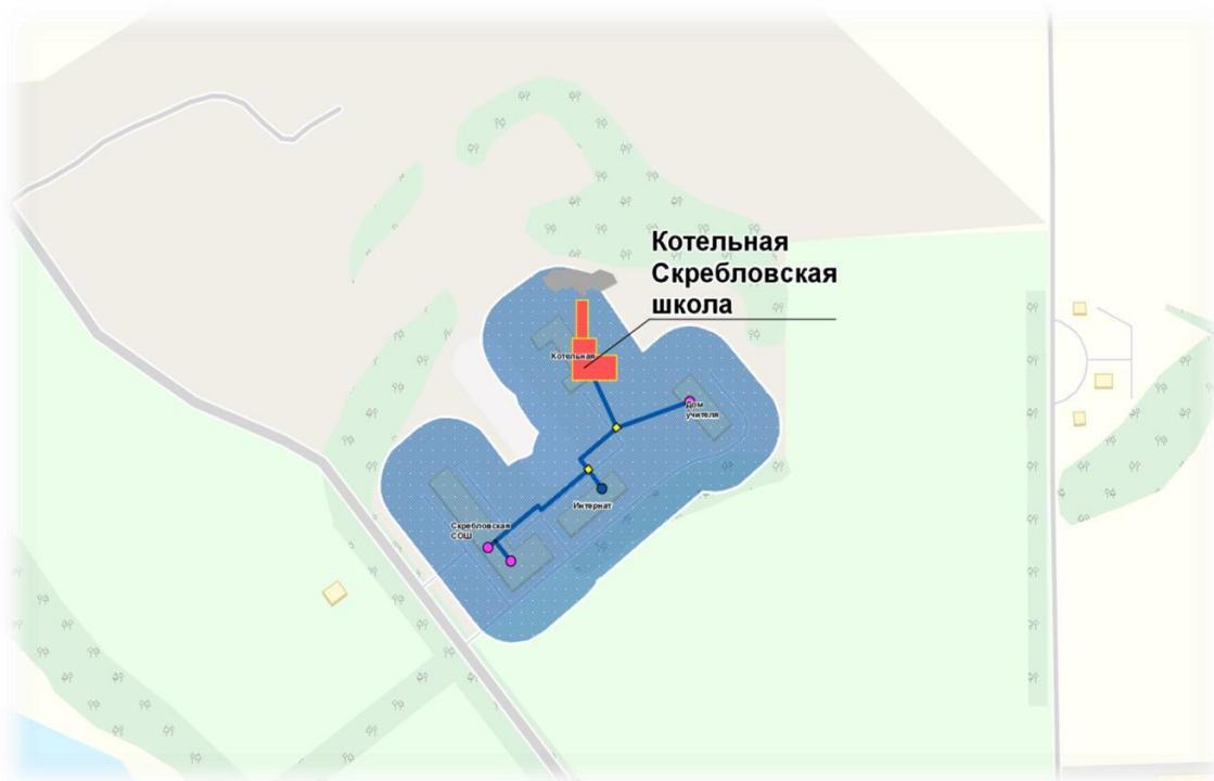
Рисунок 2 – Зона действия котельной п. Скреблово (школа)
